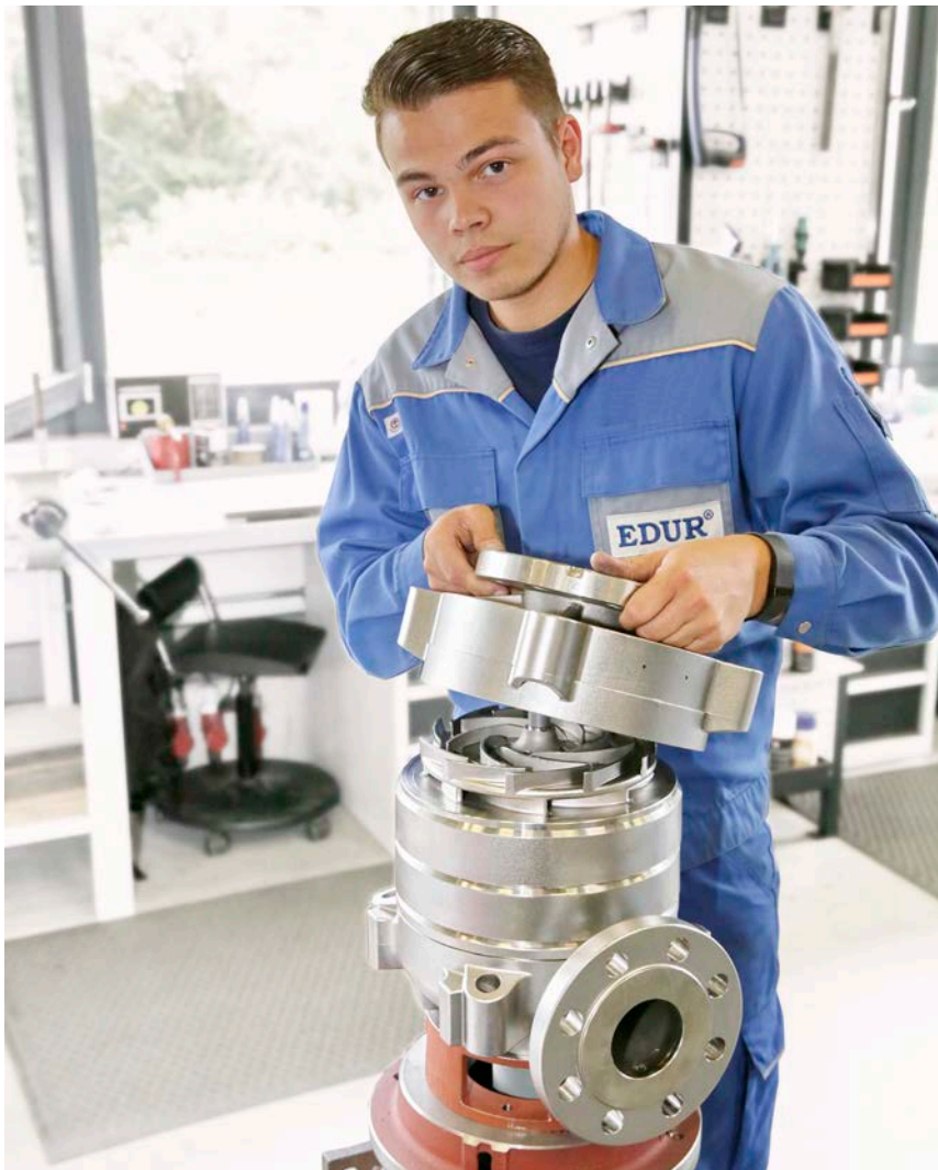
El multifase de varias etapas de la bomba EDUR durante el proceso de montaje
