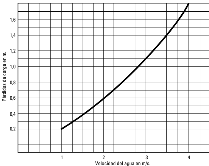
Fig 8. Perdidas de carga en válvulas de pie.
