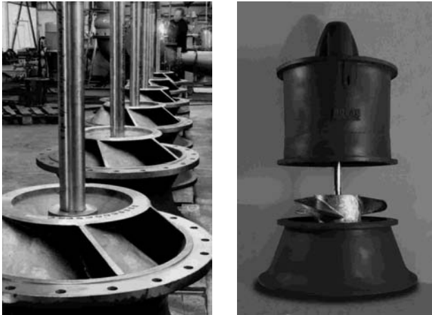
Figura 54. Bombas helicocentrífugas y bomba axial
